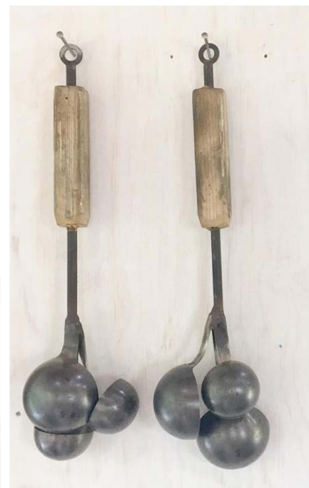
Zelfgemaakte soeplepel- gereedschappen voor het vormen van het hete glas.
